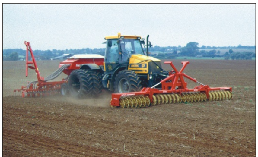
Duplex Prismenwalze® Ø 450 mm, 6 Meter, hydraulisch klappbar 3 Meter
