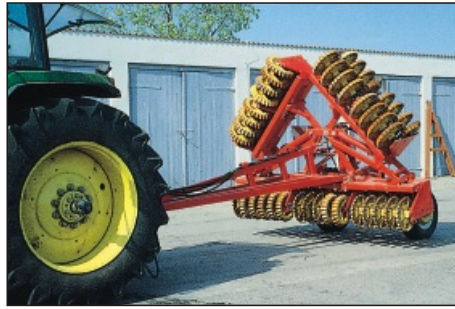
... Fahrwerk zum Anstecken, Transportbreite 3 Meter.
