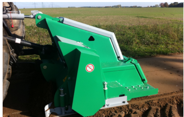
Schotterfräse HEN-WPF 200 beim Fräsen-Mischen-Profilieren-Rückverfestigen
